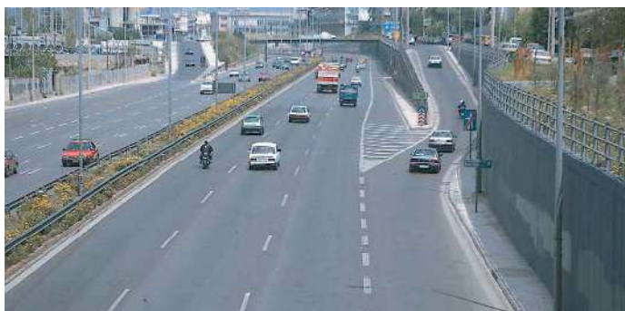
Σχ. 7.5γ Αυτοκινητόδρομος με λωρίδα επιβραδύνσεως.
