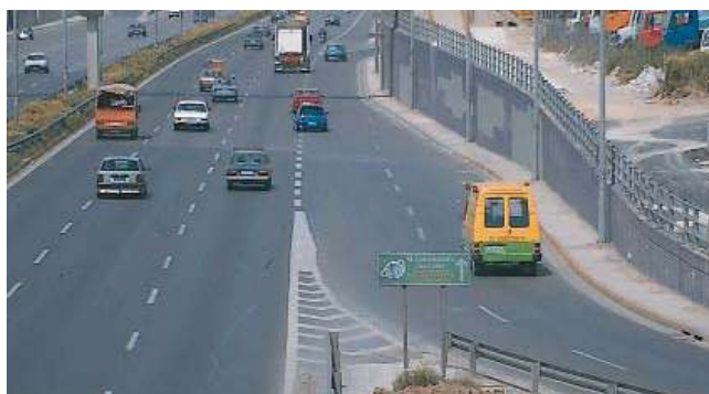
Σχ. 7.5β Αυτοκινητόδρομος με λωρίδα επιταχύνσεως.
