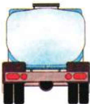
Εικ. 47 Πεπλατυσμένη διατομή βυτίου (κιβωτοειδής)
