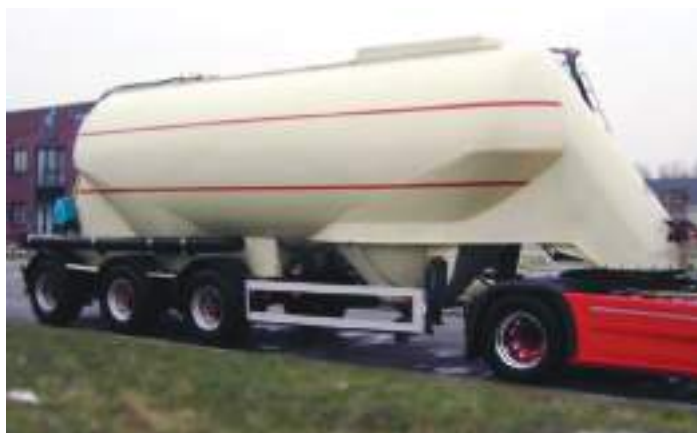
Εικ. 51 . Βυτία-σιλό για στερεές ύλες σε μορφή σκόνης ή κόκκων.
