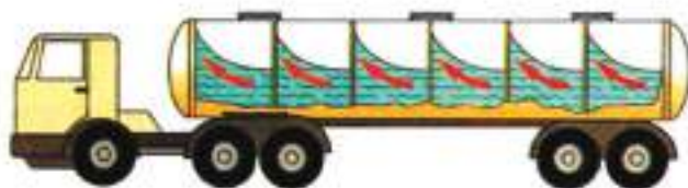
Εικ. 75 Κίνηση του υγρού εντός βυτιοφόρου που φρενάρει.
