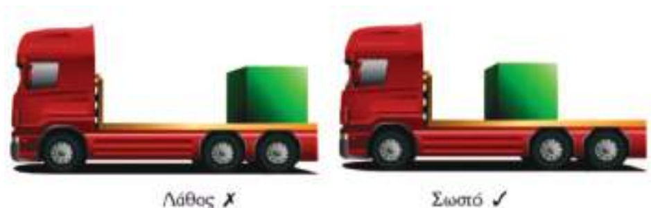
Εικ. 38 Κατά μήκος της πλατφόρμας τοποθέτηση φορτίου.
