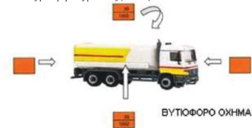
Εικ. 78. Δύο πορτοκαλί πινακίδες χωρίς αριθμούς στο εμπρόσθιο και οπίσθιο μέρος της μεταφορικής μονάδας και από μία πινακίδα με αριθμούς αναγνώρισης σε όλες τις πλευρές των βυτίων
