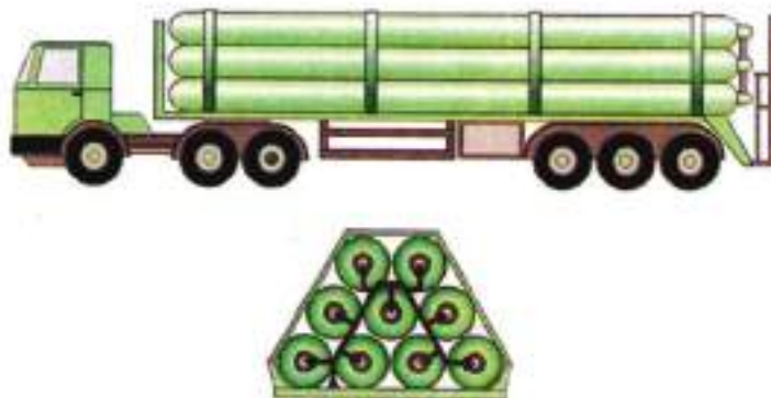
Εικ. 43 Βυτιοφόρο όχημα με συστοιχία συνδεδεμένων δοχείων (battery) για τη μεταφορά υγρών.
