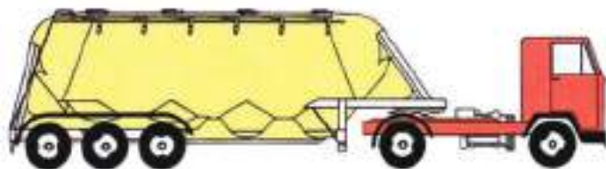
Εικ. 50 Βυτία-σιλό για στερεές ύλες σε μορφή σκόνης ή κόκκων.
